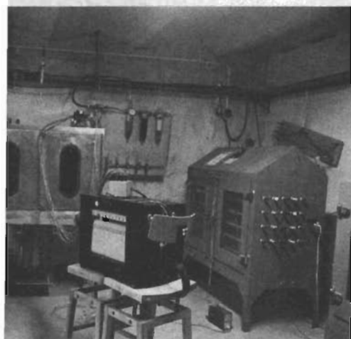
Detta är en anläggning för långtidsprov i fuktig miljö vid FOA i Stockholm. Det är ett svenskt utvecklingsarbete som innehåller en del intressanta finesser. Mera härom i artikel på annan plats i detta nummer.
