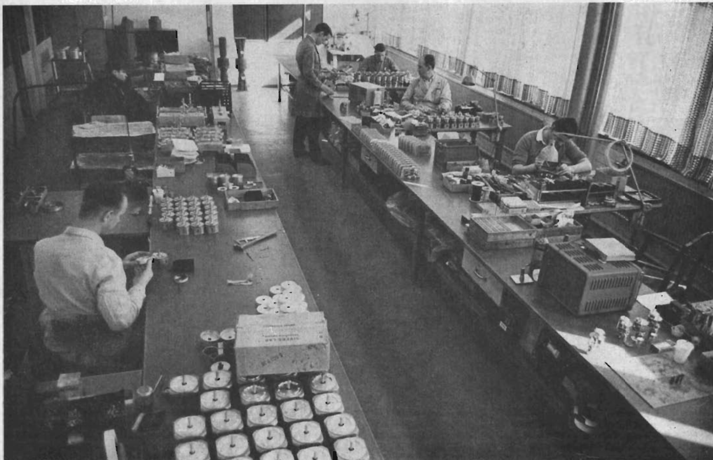
Fig. 11 En del av monteringslokalen hos Sivers Lab. Längst bort befinner sig ett antal mätledningar för vägledare, och längre fram t. v. omkopplare av olika slag.
