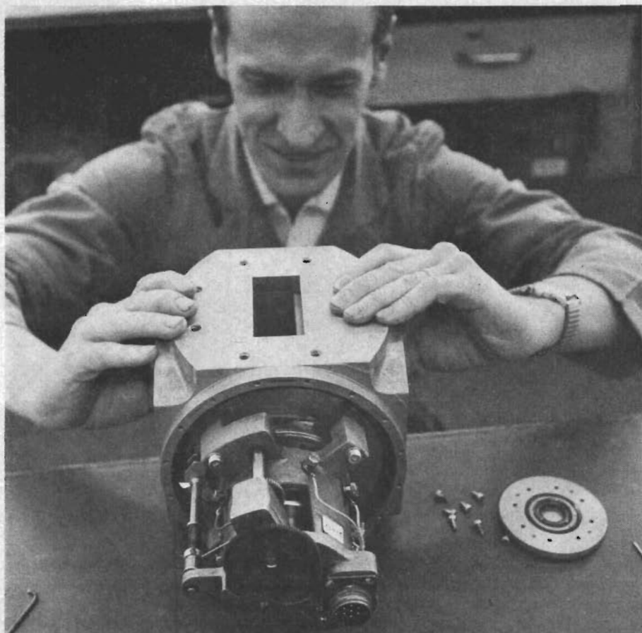
Fig. 12 En av de större omkopplartyperna, avsedd för motordrift, under tillverkningens slutskede. Den skall få en kåpa över verket i sitt färdiga skick. Omkopplarna innehåller en fjäder som utlöses vid omkoppling och som efter varje omkoppling spänns av en motor, vilken drivs med 24 V likspänning. Omkopplare som denna sitter bl. a. i radaranläggningar och i radiolänkar. De skall tåla flera miljoner slag i snabbtempo!
