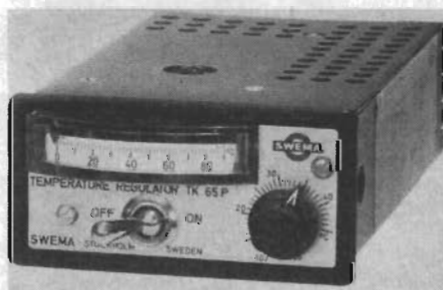
Fig 2. Temperaturregulator med tyristorer i reglerkretsarna, vilket ger kontinuerlig reglering och därigenom ett minimum av pendling i temperatur hos den övervakade temperaturkällan. (Tillverkare: Svenska Mätapparater Fabriks AB.)
