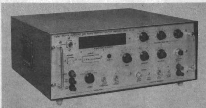
Fig 7. Överföringsfunktionsanalysator för mätning på servosystem. (Tillverkare: Weston-Boonshaft and Fuchs, USA.)
