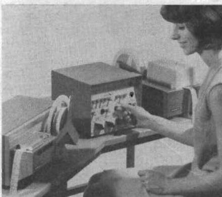
Fig 9. Kopieringsutrustning för hålremsa, vilken kan användas för kontinuerlig eller tecknvis kopiering och redigering av hålremsor. (Tillverkare: Facit AB.)
