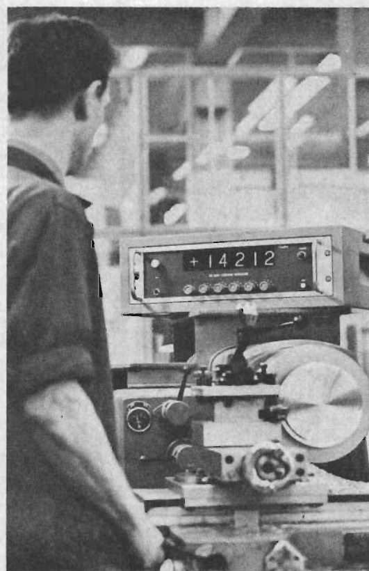
Fig 7. Positionsindikator för manuellt styrda verktygsmaskiner. (Tillverkare: Phillips.)
