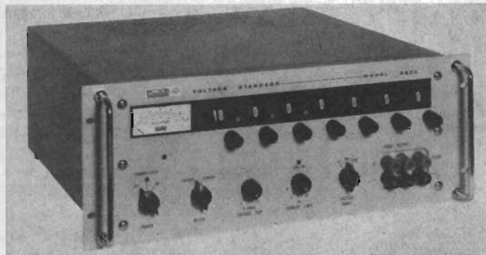
Fig 8. Likspänningskalibrator för spänningsområdet 0-1111 V, noggrannhet 0,003 %, från det amerikanska företaget John Fluke Mfg. Co. Inc.
