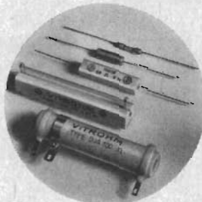
Trådlindade motstånd 0,1 \Omega - 200 k \Omega : 1 - 120 W
