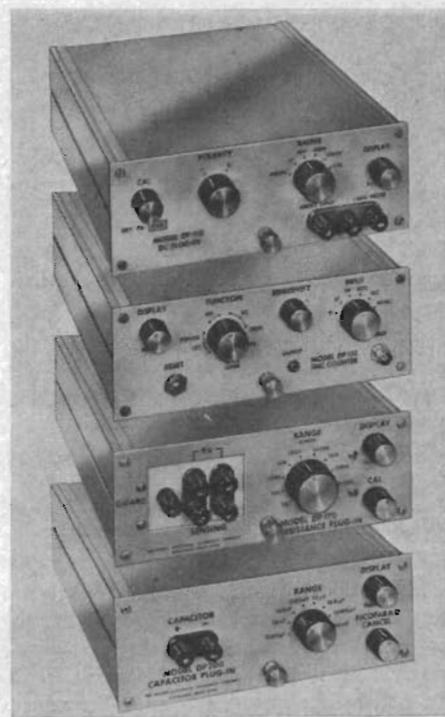
Fig 1. Digitalt mätsystem från det amerikanska företaget Hickok Electrical Instrument Co. Genom att byta plugin-enheter i systemets grundenhet kan man få följande olika digitala instrument: likspänningsvoltmeter, frekvensräknare, resistansmeter och kapacitansmeter. (Bildn t. h.)
