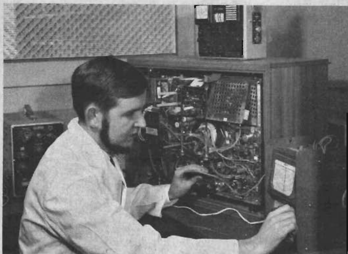
Fig 7. Sektionschefen, ingenjör Per Reppling, sysselsatt med mätningar på en TV-mottagare. Sådana mätningar utförs i en skärmbur av fabrikat Siemens. Med dörren till skärmburen stängd är till och med mottagning av 60 kW-sändarna i Nacka helt omöjlig utan yttre antennsignal, trots att man har direkt synkontakt och avståndet endast är ca 2 km.
