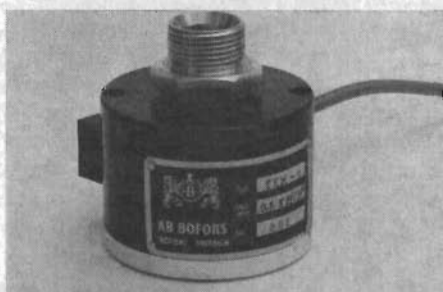
Fig 4. Tryckgivare för mätning av gas- och vätske-tryck i området 0–20 kp/cm 2 . (Tillverkare: AB Bofors.)
