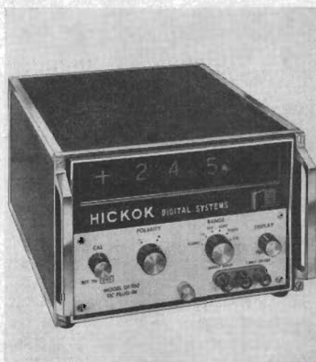
Fig 1. Digitalt mätsystem från det amerikanska företaget Hickok Electrical Instrument Co. Genom att byta plugin-enheter i systemets grundenhet kan man få följande olika digitala instrument: likspänningsvoltmeter, frekvensräknare, resistansmeter och kapacitansmeter. (Bildn t. h.)
