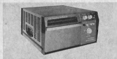
Fig 5. 12-kanals skrivare med fotografisk registrering, som tillverkas av det amerikanska företaget Consolidated Electrodynamics Inc.
