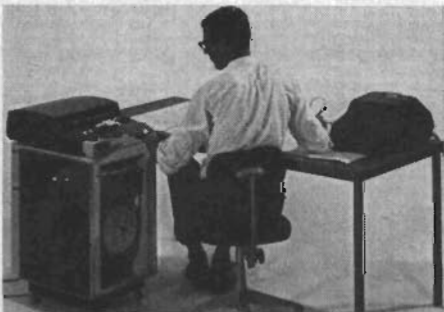
Fig 1. Bygg-ADB AB har i samarbete med Arenco Electronics AB utvecklat en sk mångdkalkylator som kan användas för datainsamling direkt från ritningar. Insamlade data registreras på hålremsa, som sedan kan matas in i en datamaskin för vidare bearbetning.
