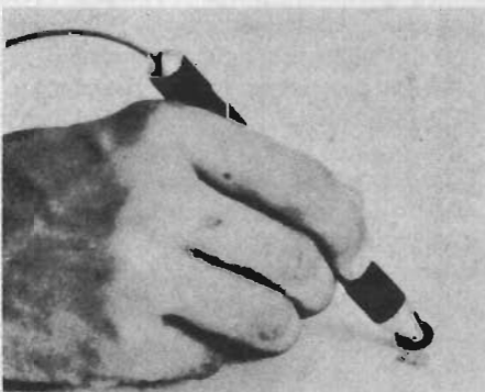
Fig 2. Vid mätning på ritningarna används en specialpenna med spets i form av en trissa. Denna rullas längs de mått som skall mätas.
