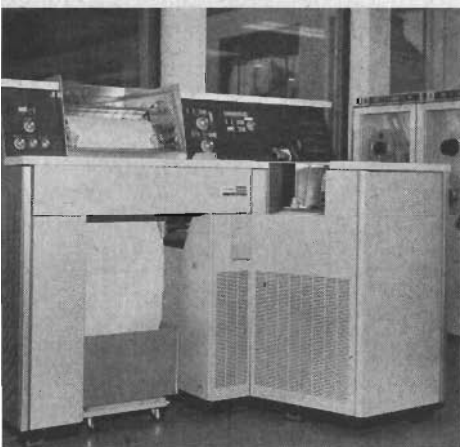
Fig 3. Data-maskinen Univac 1004 används bl a som terminal-maskin för kommunikation med stora centralt placerade data-maskiner.
