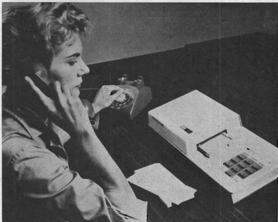
Fig 6. Utrustning, typ IBM 1001, för överföring av data från hålkort.
