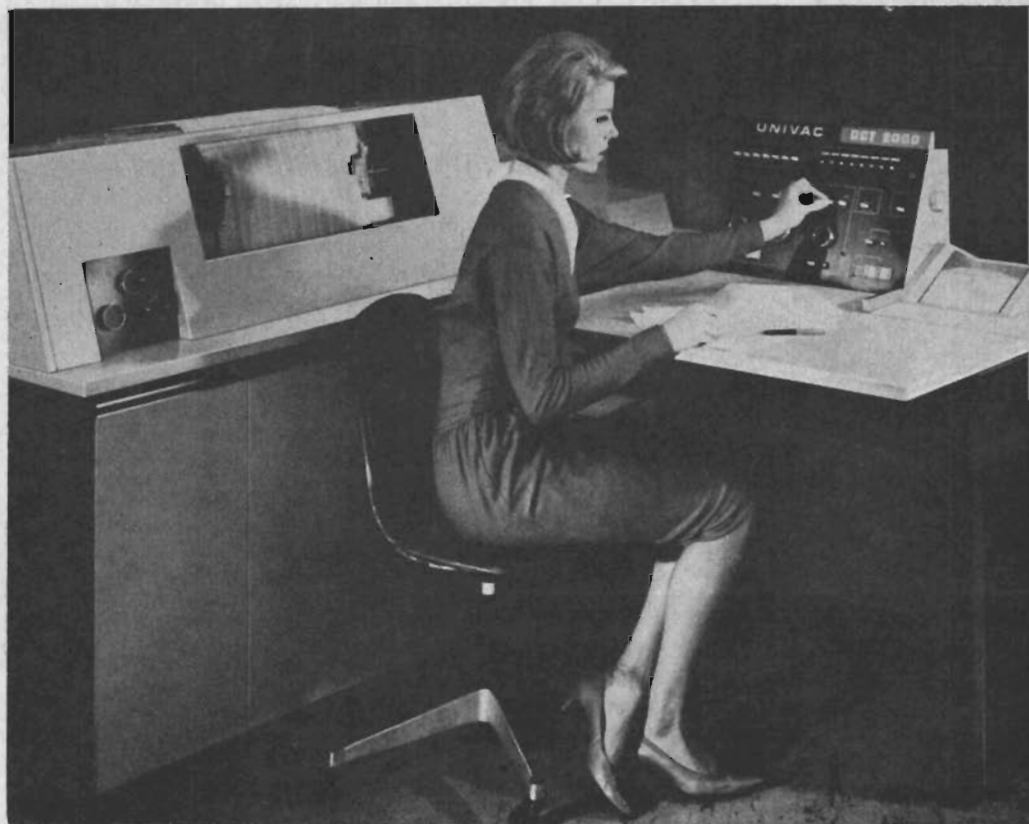
Fig 4. Utrustning för datakommunikation, typ DCT 2000 från Univac. Utrustningen består av en kombinerad hålkortsstans och -läsare, en radskrivare, styrenhet och operatörskonsol.
