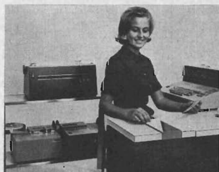
Fig 5. Datakommunikationsutrustningen typ IBM 1050 arbetar med en överföringshastighet av 15 tecken per sekund.
