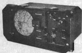
Fig 3. Den navigeringsutrustning för fordon som Ferranti utvecklat återger fordonets position och färdriktning direkt på kartbilden på indikatorskärmen.
