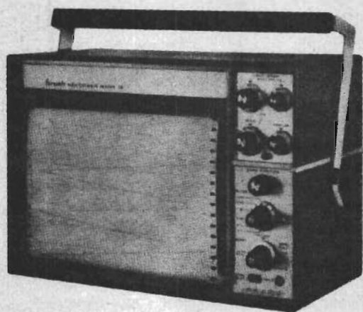
Fig 1. En modern direktskrivare avsedd för registrering av låga signalnivåer.
