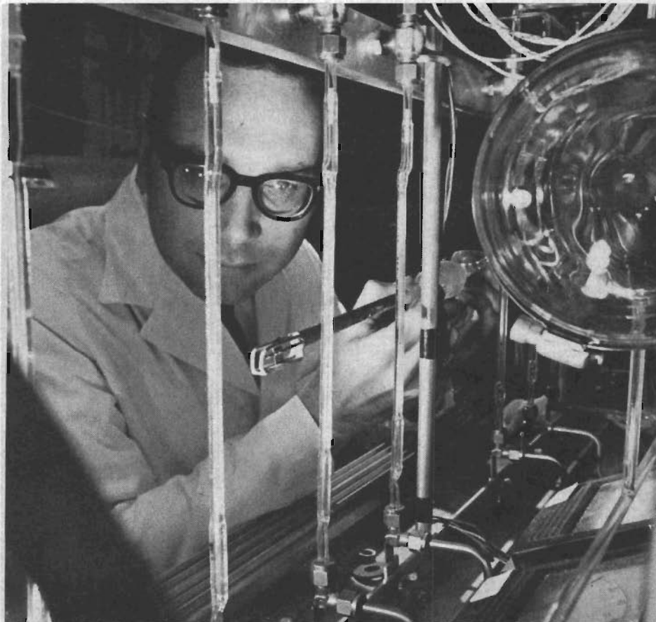
Fig 1. Undersökning av en just framställd kristall av GaAs. Kristallen syns stående i hållaren i änden på kvartsstaven. Tillverkningsapparaturen skymtar till höger.
