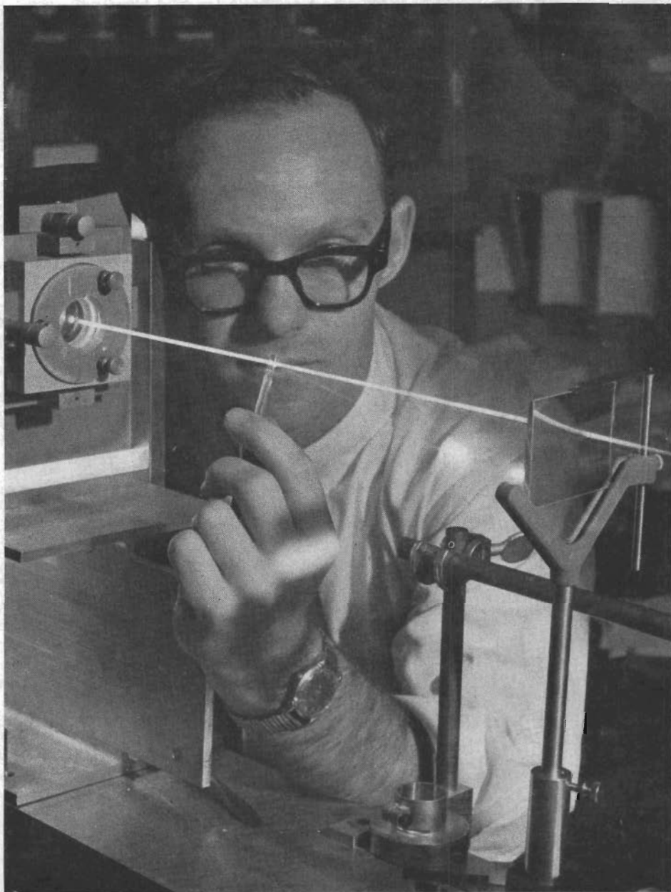
Fig 6. Galliumfosfid (GaP) kan användas för modulering av koherent ljus. En kristall av GaP i mannens hand blockerar här delvis en laserstråle.
