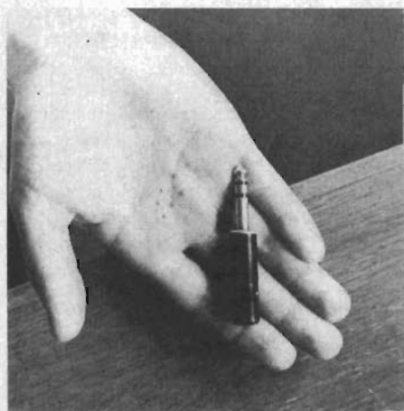
Fig 5. Dosimeter för neutronstrålning utvecklad av Hafo och Foa. Det strålningskänsliga halvledarelementet – en speciellt utformad kiseldiod – är anbringat inne i telefonproppen. De små kornen i handen är de strålningskänsliga dioder som ingår i dosimetrarna.
