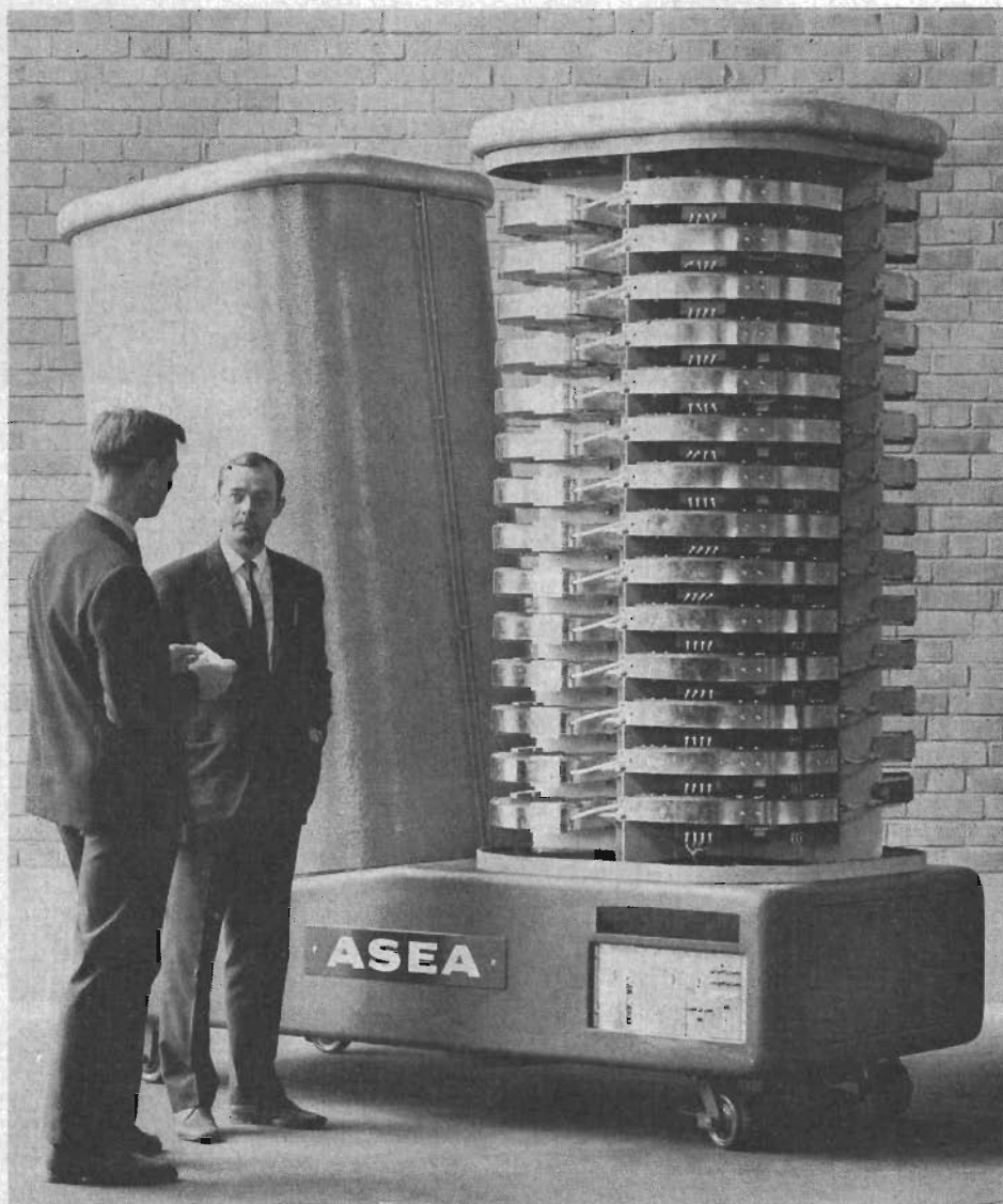
Aseas tyristorventil för 50 kV, 200 A, som f n prövas i systemet för överföring av likspänning mellan Gotland och fastlandet. Tyristorventilen, som innehåller 50 seriekopplade tyristorer, styrs av ljuspulser.
