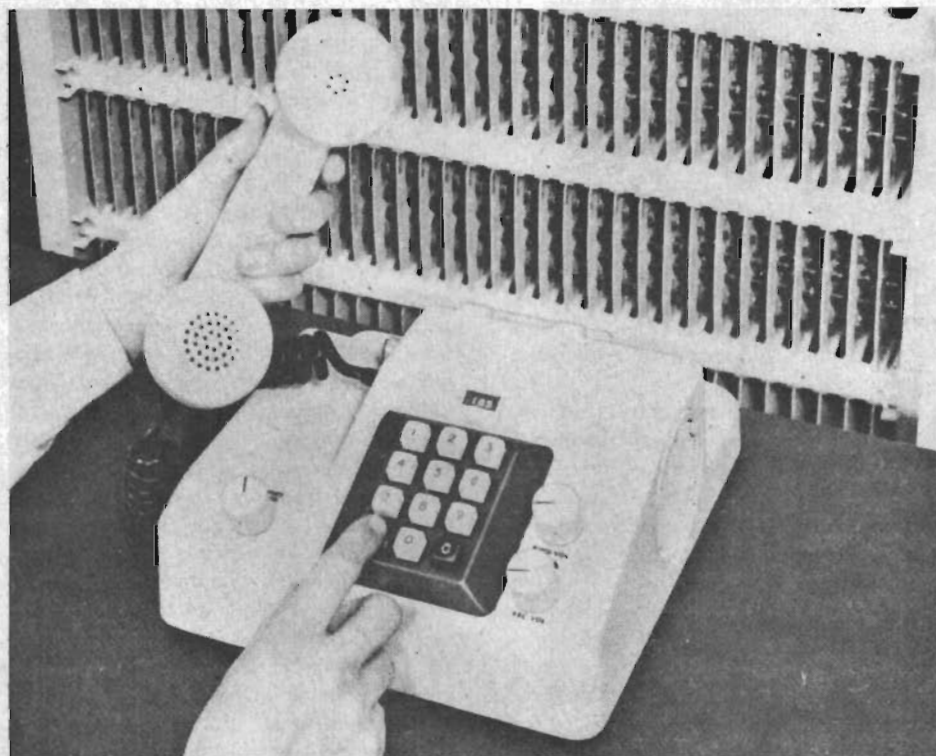
Fig 3. Telefonapparater med knappsats har bl a den fördelen att de medger snabbare nummerslagning än apparater med fingerskiva.
