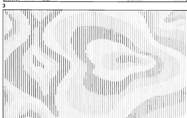
Fig 5. a) Principschema för automatisk mätning av höjdnivåer och motsvarande restitution. Apparatur: Zeiss »Stereo-Trigomat». Fig 5. b) Olika typer av markeringar, ritade automatiskt med utgångspunkt i samma höjdinformationer (Zeiss »Orographe»); 1) orogram med prickar, 2) orogram med brutna streck av konstant tjocklek, 3) orogram med brutna streck av varierande tjocklek och 4) orogram med sammanhängande streck av varierande tjocklek.
