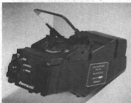
Fig 6. Bomb- och raketsikte av typ ISIS F (Ferranti Ltd).
