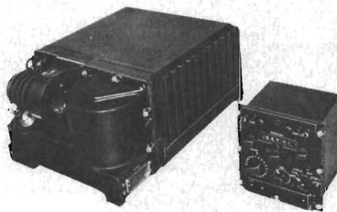
Fig 4. Kombinerad VHF/UHF-transceiver för 3 500 UHF-kanaler och 370 VHF-kanaler (Plessey Co Ltd).
