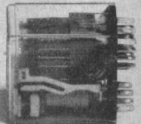
Med magnetisk låsning 5. Miniaturrelä med magnetisk låsning av ankarfunktionen. I övrigt lika 1, 2 och 4.
