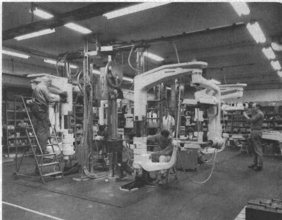
Fig 1. De företag som idag bildar Elema-Schönander AB, började sin verksamhet inom röntgenområdet. Röntgenutrustning utgör fortfarande en av grundstenarna i företagets aktuella tillverkningsprogram. På bilden visas monteringen av Elema-Schönanders utrustning för skullröntgen.
