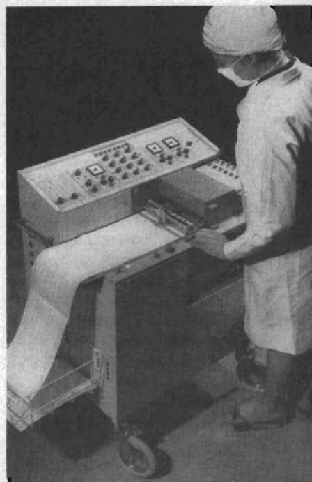
Fig 7. Inom såväl praktisk sjukvård som medicinsk forskning används i stor utsträckning mångkanaliga biofysikaliska skrivare. Den på bilden visade skrivaren, »Mingograf 81», kan utrustas med upp till 8 registreringskanaler. För att man skall få största möjliga flexibilitet kan kanalerna förses med olika typer av anpassningsnät och förstärkare för olika typer av registreringar.
