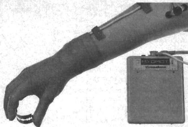
Fig 13. En i Sverige tillgänglig handprotes med myosignalstyrning. Den är tillverkad av Viennatone, Österrike och Otto Bock, Västtyskland. Den har en frihetsgrad och aktiv återgång. Elektronikdelen kan bäras i fickan.
