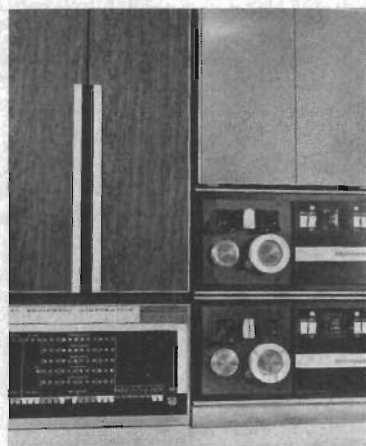
Fig 6. För övervakning samt för bearbetning och utskrift av analysresultaten används en datamaskin, typ PDP 8, från Digital Equipment Corp, USA. På bilden ses en del av datamaskinens manöverpanel samt två små magnetbandstationer, som kan anslutas till maskinen för att öka dess användbarhet.
