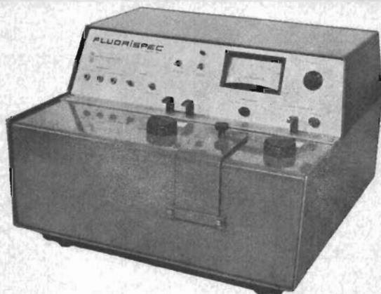
FLUORESCENSSPECTROPHOTOMETER med två dubbelmonokromatorer. Känslighet: 10^{-9} kininsulfat i 0,1 N svavelsyra Upplösning: 2 nm
