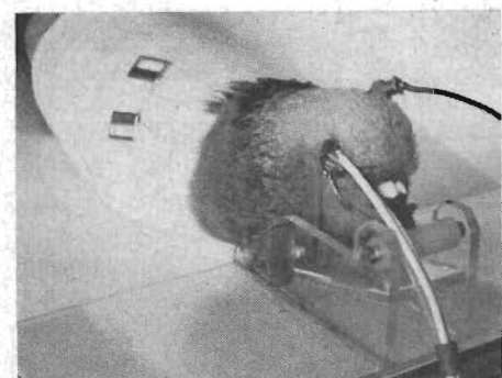
Fig 2. Laserstrålningen förbättrar väsentligt upptagningen av ERG (elektroretinogram). Här tas ett ERG på en duva. Ingreppet är smärtfritt.
