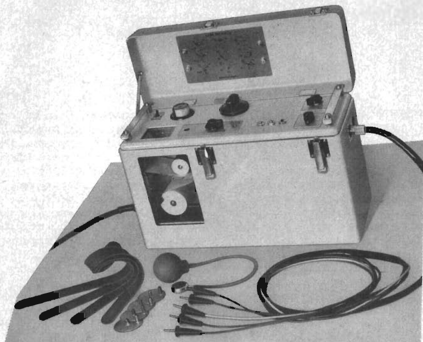
Fig 6. År 1950 presenterade Elema-Schönander sin första direkt-skrivare, en 1-kanals elektrokardiograf, med den av med dr Rune Elmqvist utvecklade strålgalvanometern. Tack vare denna galvanometer kan man göra registrering av frekvenser upp till 1 000 Hz.
