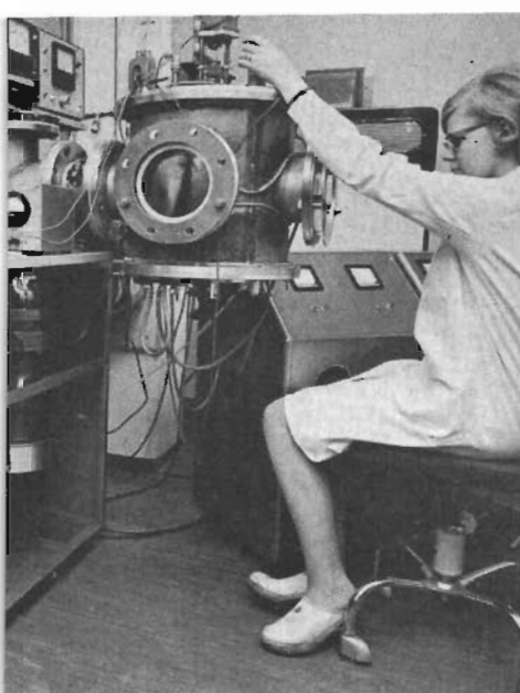
Fig 2. Förångningsanläggningen är uppbyggd med ett standardpumpställ som grundenhet. Förångningskällorna sitter i vakuumkammarens botten. Substraten placeras på en roterande skiva i kammarens övre del.
