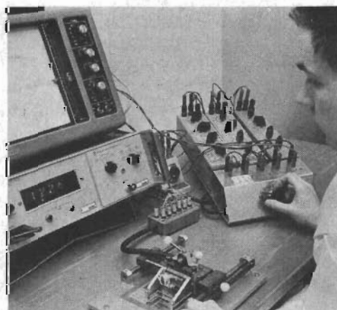
Fig 7. Resistanser och temperaturkoefficienter kontrolleras med hjälp av en digital ohmmeter och en X-Y-skrivare.
