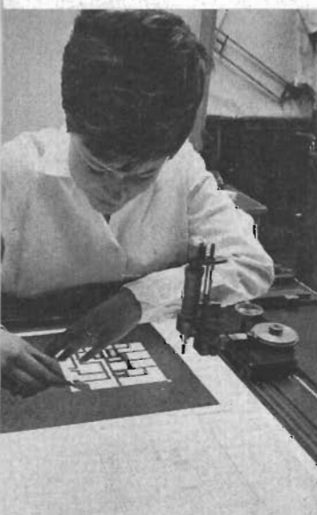
Fig 4. Med kretslayouten som underlag skärs mönstret ut i dubbel plastfolie med en koordinatograf. Arbetet förenklas genom att man använder standardmått och standardledningar.
