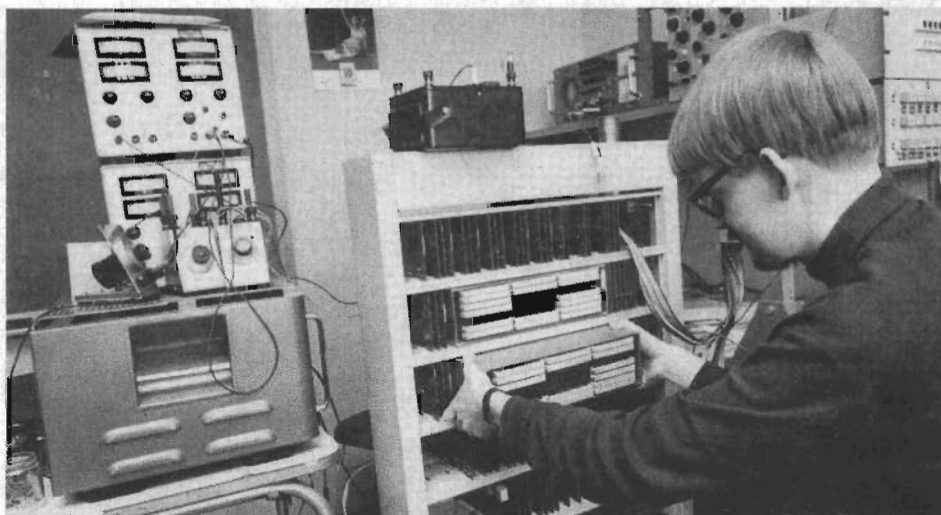
Fig 6. Man har nu utvecklat minnen för PMS-systemet, som är dubbelt så snabba som de man först använde. På bilden visas en provutrustning i vilken en minnesenhet av den nya snabbare typen sätts in.
