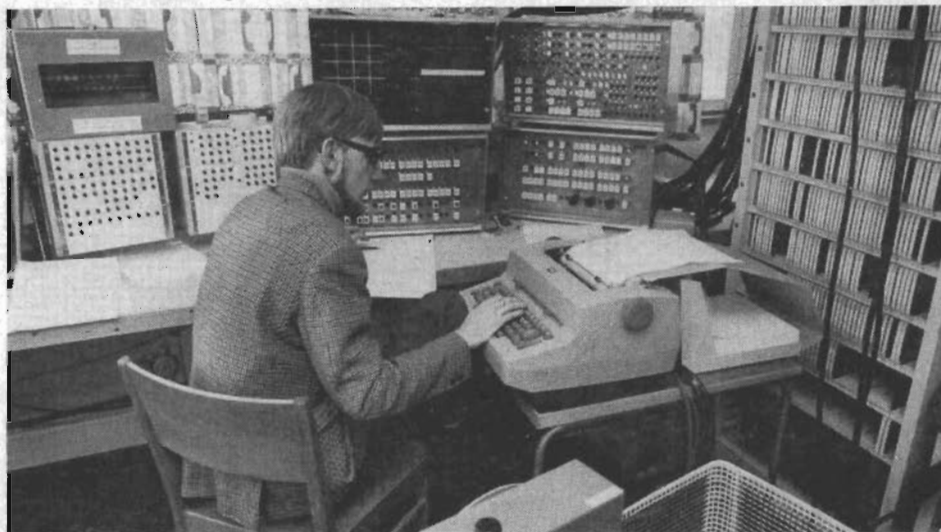
Fig 4. Här pågår provning av de program som används i PMS-systemet. De provenheter som ses i bakgrunden används för att generera de funktioner i programmet som man vill prova. Resultatet av proven skrivs ut på den till utrustningen kopplade skrivmaskinen.
