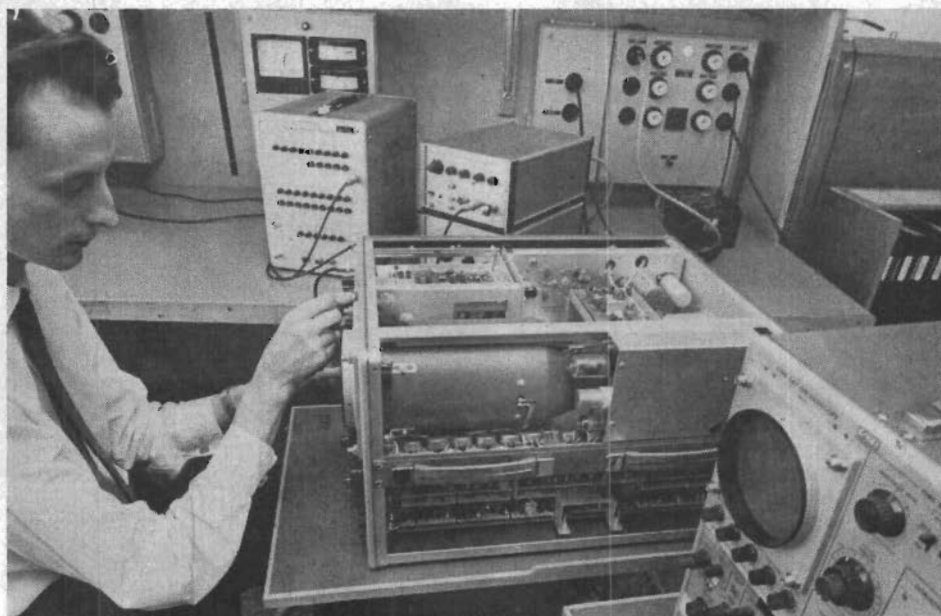
Fig 9. En viktig del av laboratoriearbetet är kontroll och justering av de instrument som används. På bilden kontrolleras ett oscilloskop.
