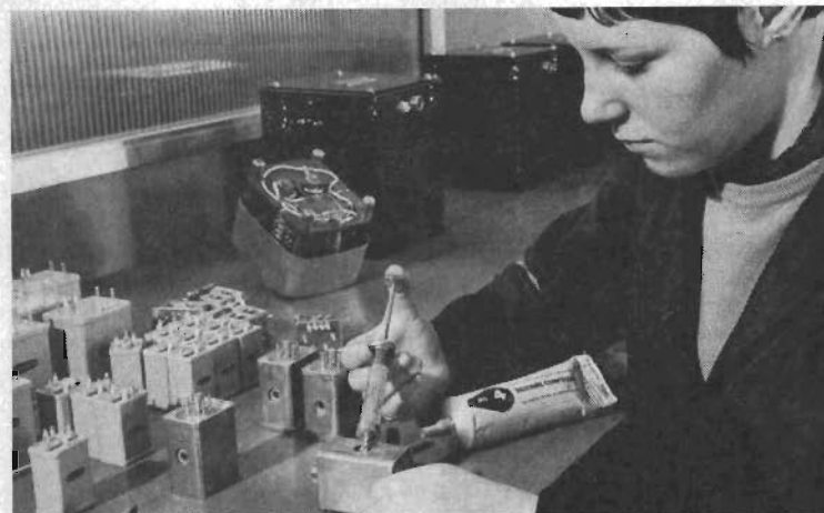
Fig 4. Ett kretskort för en flygburen utrustning bestrys med ett flexibelt silikonlack, som ger ett gott skydd.
