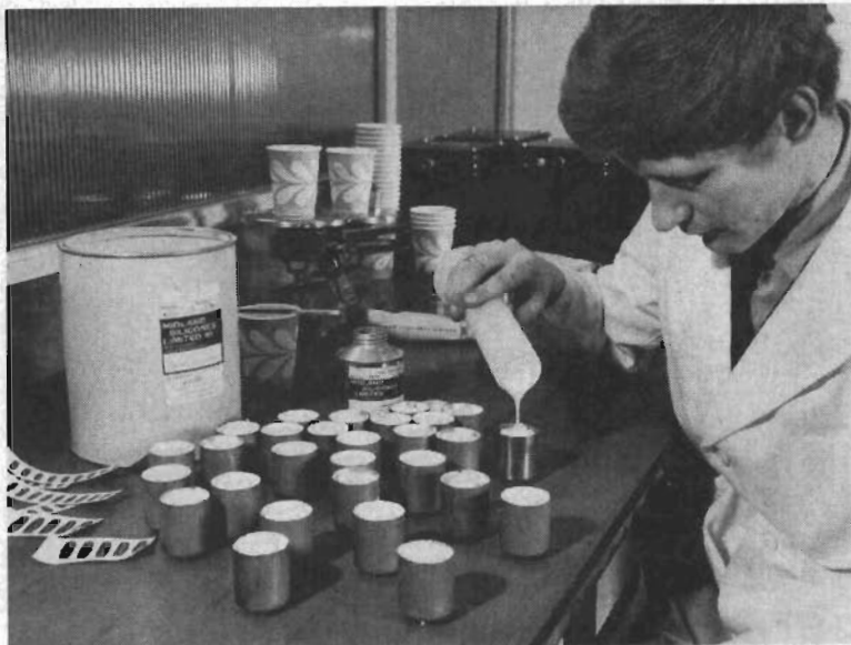
Fig 1. Miniaturtransformatorer för luftburen militär utrustning innesluts i kallhär-dande silikoner.
