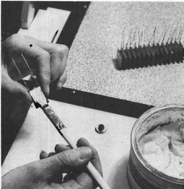
Fig 6. Silikonpasta penslas på »thermagotrone» under den slutliga testningen för att värmeavledningen skall förbättras. (Thermagotrone är termoelektriska komponenter som används bl a för att alstra UHF-signaler.)
