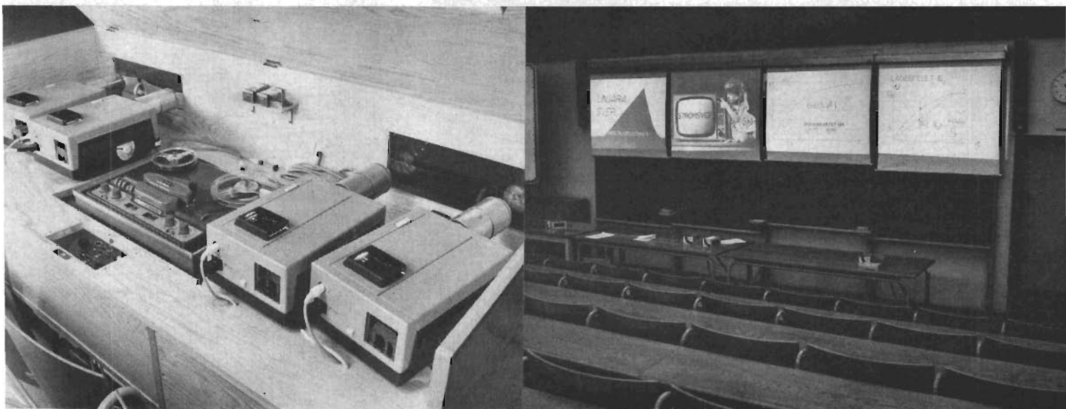
Fig 3. För visning av stillfilmer används ett system med fyra projektorer och bandspelare.
