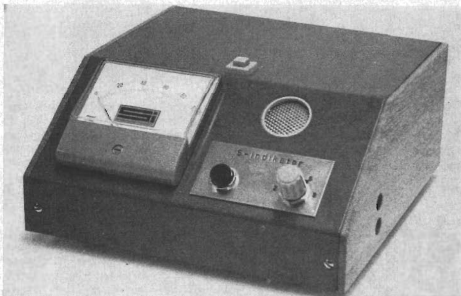
Fig 5. S-indikator. Apparaten används i huvudsak för träning av »s» men kan i viss utsträckning också användas för andra frikativor. Kvaliteten hos ett s-ljud visas som ett utslag på visarinstrumentet. För att ljudet skall uppfattas som ett gott »s» måste utslaget vara minst 60 skaldelar. En lampa tänds då utslaget överskrider ett värde som kan ställas in med rattet. Träning med hjälp av lampan används då s-ljudet skall tränas i ord eller meningar, medan visarinstrumentet ger större möjlighet att hitta tungställningen för ett riktigt s-ljud.
