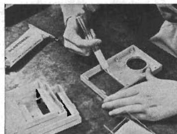
Fönstret i Evershed's megger BM6 är säkert limmat i plastkåpan med Silastoseal B, som ger en permanent lufttät fog vilken utesluter damm och fukt.
