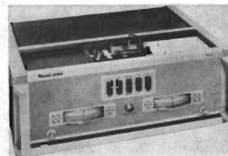
Fig 1. Laborationsutrustning från Asea Education. Längst ned till vänster visas matningsenheten och ovanför denna glättningsreaktorn. Andra enheten från vänster är strömriktarenheten och under denna visas en trefas icke styrd likriktare. Längst till höger ses kopplingspulpsten.
