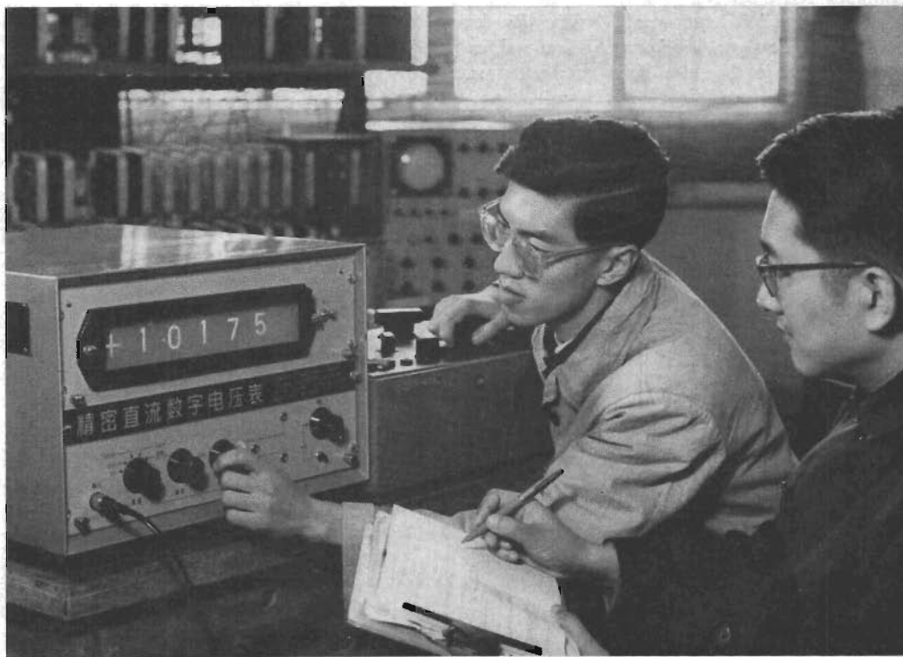
Fig 3. Kinas första digitala voltmeter. Instrumentet är transistoriserat. Det tillverkas av Shanghai Electric Instruments and Meters Research Institute.
