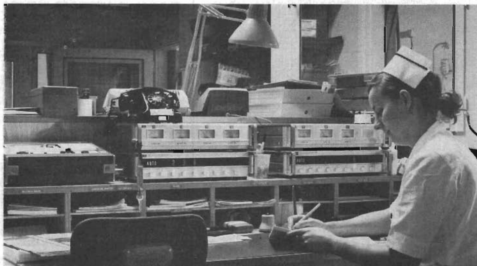
Fig 3. Övervakningsutrustningens central är placerad i ett rum från vilket man har insyn till patientrummen. Centralutrustningen består av två patientväljare, indikatorenheter för hjärtfrekvensen, två elektrokardiografer samt två flerkanals oscilloskop för kontinuerlig presentation av patienternas elektrokardiogram.
