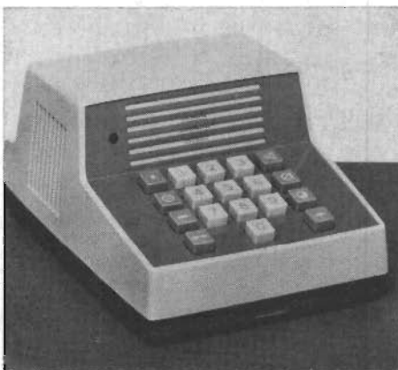
Fig 8. Intercom-enheten används både som terminalenhet för inmatning av data och som snabbtelefon.
