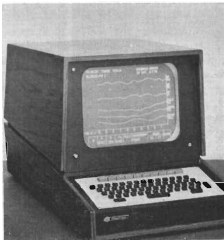
Fig 5. Grafoskopet är en direktansluten terminalenhet för dubbelriktad kommunikation i reell tid med en datamaskin.
