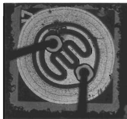
Fig 15. En transient har drivit denna transistor till sekundärt genombrott med åtföljande genomlegering.
