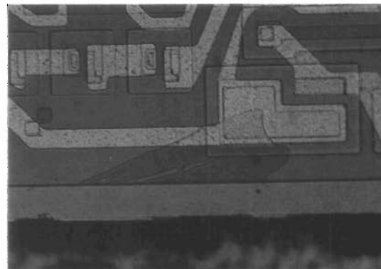
Fig 9. Maskfel orsakat av fel i resistprocessen.
