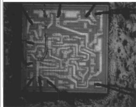
Fig 7. Repor i kristallytan kan orsaka katastroffel — avbrott eller kortslutning — när kretsen använts en tid.
