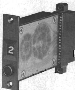
Fig 1. Sifferhjulet används i tumhjulsomkopplare och liknande manuella omkopplare. I denna tryckomkopplare, typ Uniset, är kontakterna utförda i form av ett kretskort.
