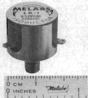
Fig 1. Isoductorn har mycket små dimensioner; den är inte större än en effekttransistor. Denna Isoductor är avsedd för 10 W.
