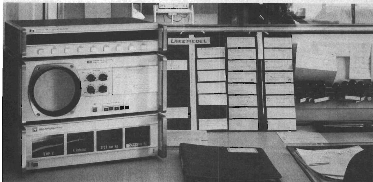
Fig 3. Centralenheten för Hewlett-Packards utrustning för intensivövervakning, installerad på Bollnäs sjukhus.
