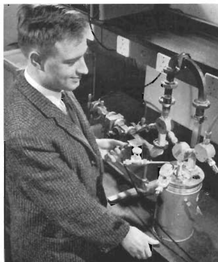
Förstärkningen mäts i en lågbrusig parametrisks förstärkare för S-bandet. Mullard Research Laboratories, Salfords.
