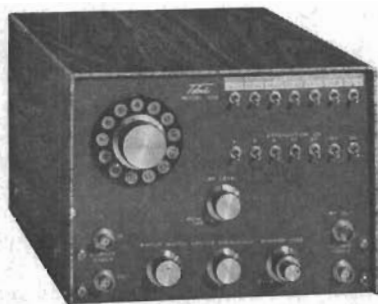
Serie 1010, svepgeneratorer för VHF-TV och mellanfrekvenser (20–240 MHz, kanal 2–13). Stegreglerad avstämning. Plug In-kort för önskad TV-frekvensstandard.
