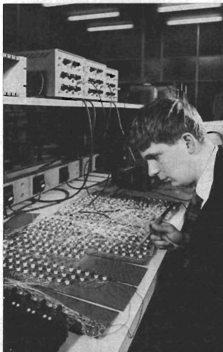
Fig 2. Provuppkoppling med specialtillverkade mikrokretsar vid Marconi-Elliott Microelectronics applikationslaboratorium.
