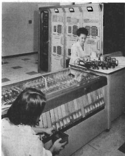
Fig 1. En del av den automatiska provningsutrustningen vid Ferrantis halvledarfabrik. Utrustningen på bilden används för provning av stora kvantiteter av plastkapslade transistorer.
