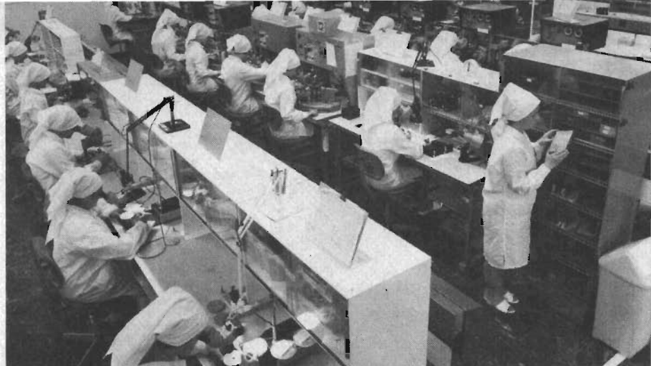
Fig 2. Ett av de luftkonditionerade »rena» rummen för montering av integrerade kretsar vid fabriken i Southampton.
