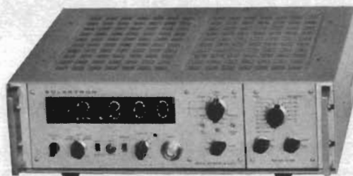
LM 1420.2 BA. Pris: 9 900:— DC 0,05 %, upplösning 2,5 \mu V AC 0,35 %, RMS-avkänning; 10 \mu V
