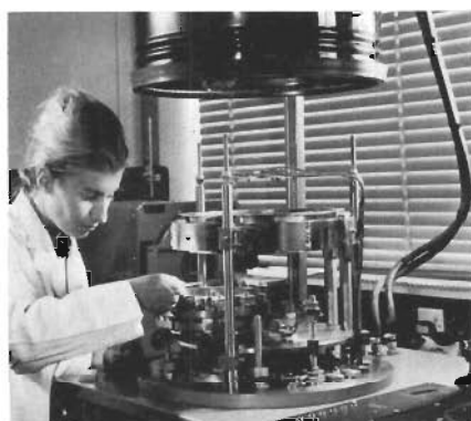
För att förbättra egenskaperna hos ljussändare i GaAs kan det vara nödvändigt att förse delar av ytan med speglar. Bilden visar en utrustning för framställning av sådana speglar med hjälp av en förångningsteknik. Mullard Research Laboratories, Salfords
