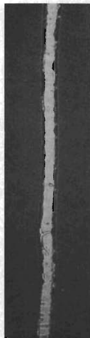
Fig 3 a. Exempel på mönster exponerat med elektronstråle. b) Förstoring av en 5 \mu\text{m} bred linje exponerad i fotoresist med en elektronstråle med 1,5 \mu\text{m} diameter.
