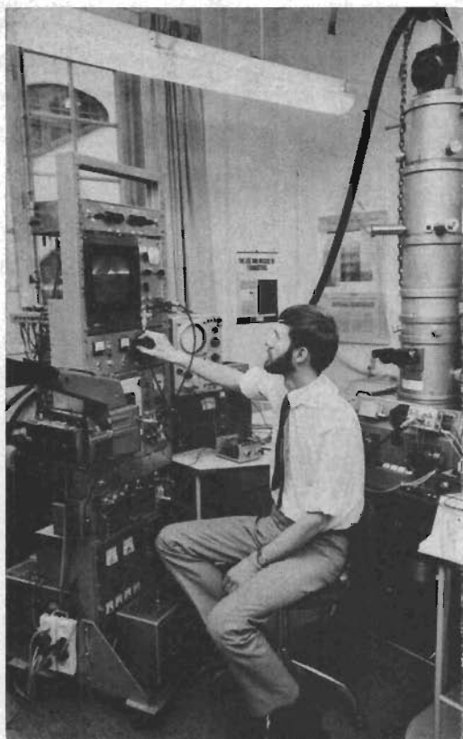
Fig 2. Ingenjör Christer Blomquist under arbete med Transistorgruppens avsökande elektronmikroskop/elektronstrålefräs. Till vänster syns den elektronoptiska kolonnen. Stativet till höger innehåller spänningsaggregat, svepgenerator, videoförstärkare samt monitorer till elektronmikroskopet.
