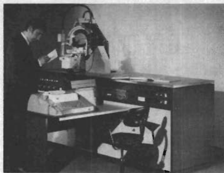
Fig 3. En datorstyrd röntgendiffraktometer får tjänstgöra som exempel på de avancerade utrustningar Philips tillverkar för vetenskapligt bruk.
