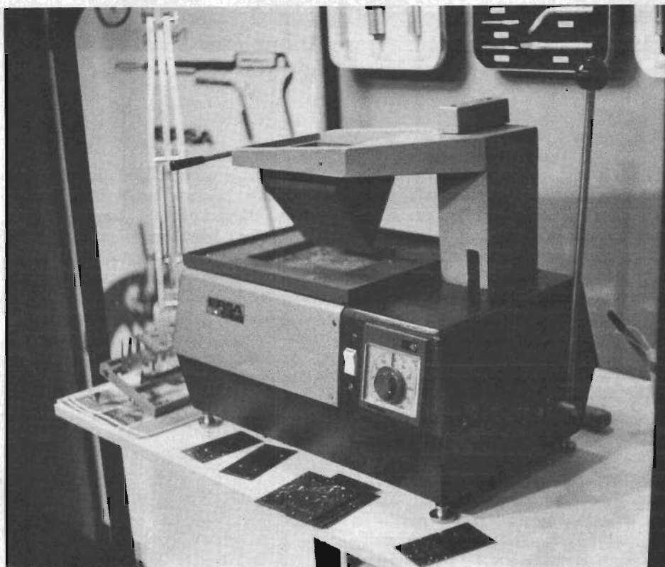
Fig 3. Dopplöddapparat från Ernst Sachs KG. Två versioner finns, T 2800 och T 3300.
