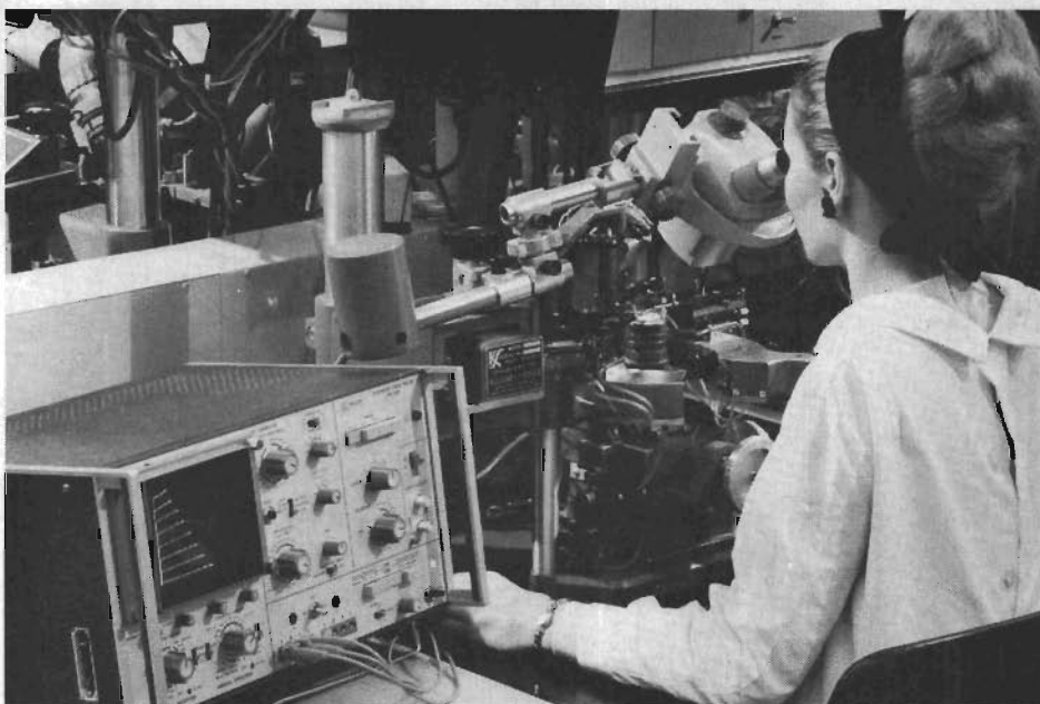
Fig 2. Philips »curve tracer» PM 6507 har utvecklats vid ett koncernföretag i Schweiz. Instrumentet på bilden är uppställt vid en mätplats i en fabrik för halvledartillverkning.
