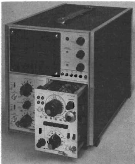
Fig 4. De transistorbestyckade oscilloskopen OS 2000 och OS 2100 från Advance är utförda med plug in-system.
