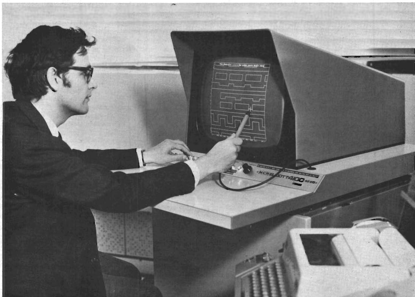
Fig 1. Bildskärm med ljuspenna hos Racal. Bilden visar layout av en mask för tillverkning av MOS-kretsar.
