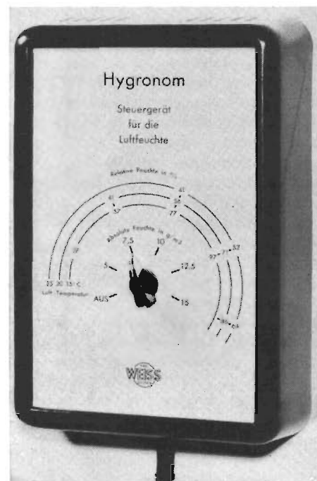
Fig 6. LiCl-sond för mätning och styrning av fuktighet. Sonden, som arbetar med en noggrannhet på \pm 0,5^\circ\text{C} daggpunktstemperatur, kan anslutas till skrivare eller visarinstrument.
