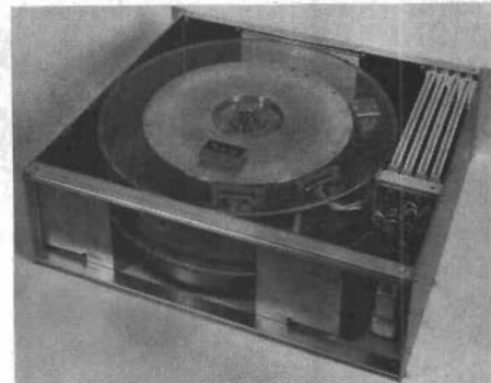
Fig 2. Trumminnet J102 från Sperry. Minneskapaciteten är 1,5 miljoner bitar. Frekvensen för in- och utmatning är 1,5 MHz vid 3 000 r/m hos trumman. Antalet spår är 48 och effektförbrukningen är endast 100 W.
