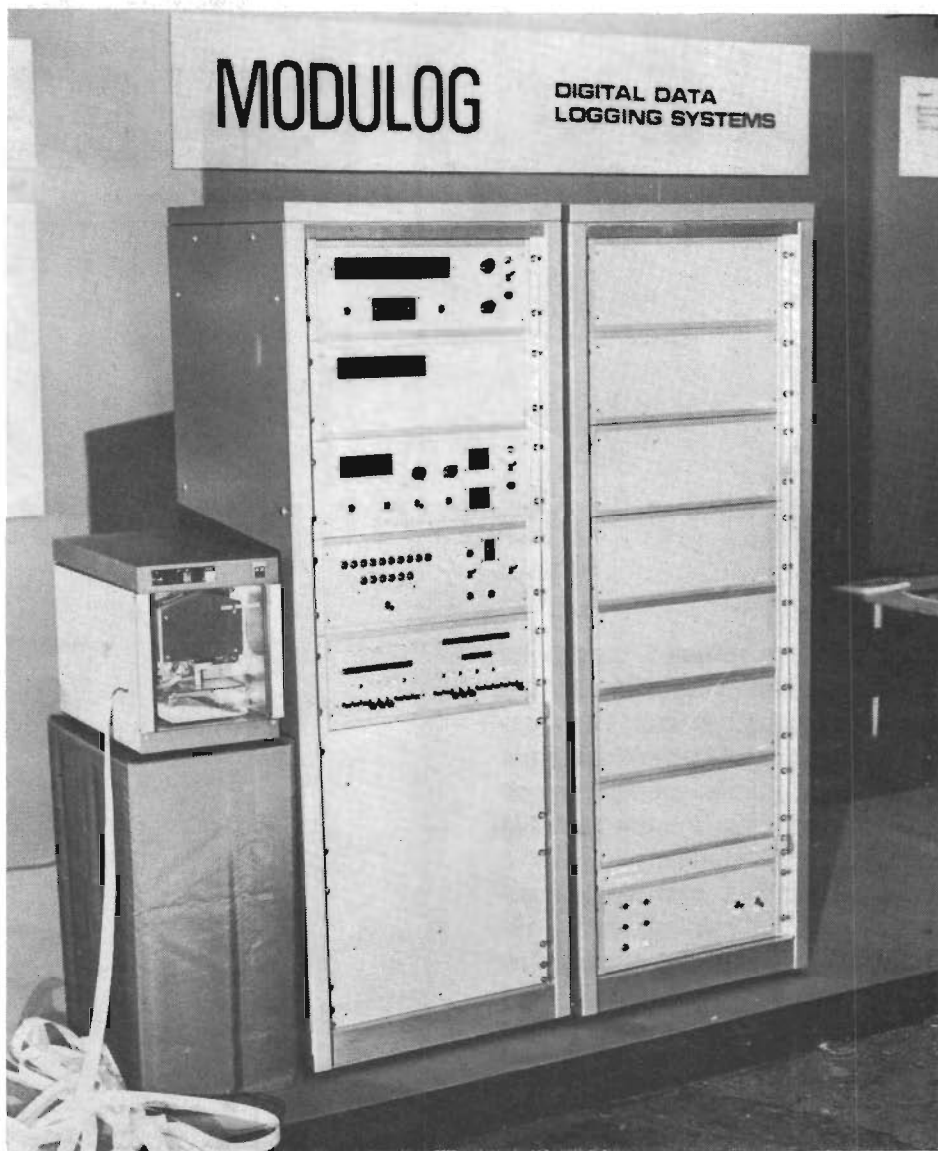
Fig 3. Datasamlingsystemet Modulog, utfört i modulsystem och med en kapacitet av upp till 1 000 kanaler. Tillverkas av Intercole Systems Ltd, England.
