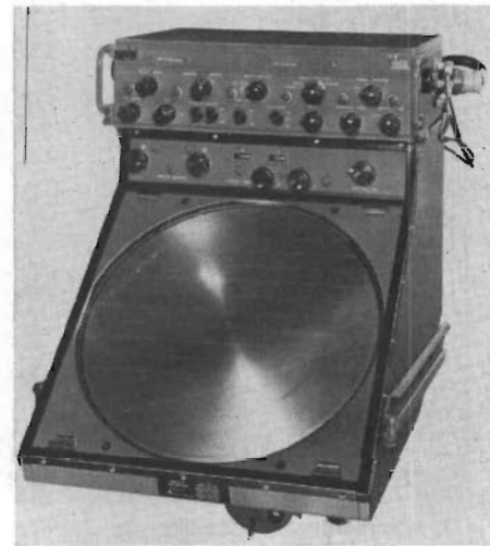
Fig 11. Ekcos presentationsenhet med projektoroptik och drygt 40 cm bildskärmsdiameter.
