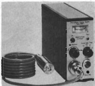
Fig 3. Ljudtryckmätutrustning från Brüel & Kjaer.
