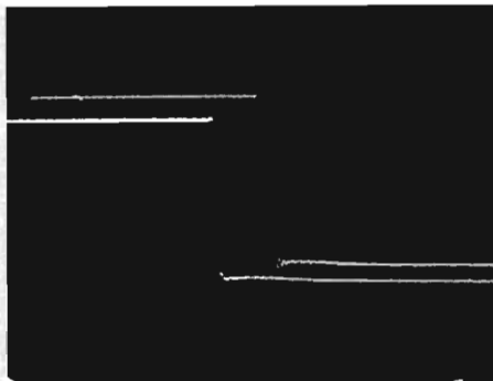
Fig 5. Ringning efter snabb puls. Vid registreringen till höger på bilden har en yttre dämpsats kopplats bort och dämpningen i den inbyggda dämpsatsen har ökat i motsvarande grad.
