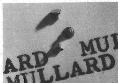
Fig 2. Tunneldioden AEY16 för lågbrusiga mikrovågsförstärkare upp till S-bandet. Dioden är 1,5 mm i diameter och 1,4 mm lång och har en övre gränsfrekvens av 10 GHz.
