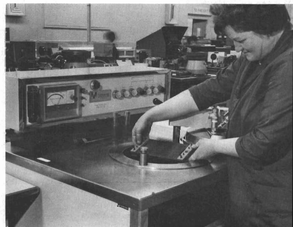
Fig 2. Utrustning för automatisk kapsling av direktkontakterade dioder.
