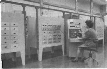
Fig 6. Ugnar för åldring av tantalkondensatorer. Operatrisen mäter läckströmmar och effektfaktorer.
