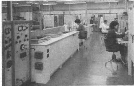
Fig 5. Produktionskedja för tillverkning av tantalkondensatorer. I förgrunden syns en enhet med ett elektrolytsbad för påläggning av dielektrikum.
