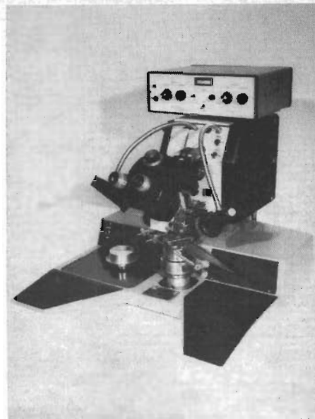
Fig 9. Apparatur för trådkontaktering med ultraljud, här med hållare för dual-in-line-kapsel.
