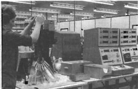
Fig 4. Utrustning för automatisk provning av dioder. Upp till 16 parametrar kan mätas. Utrustningen klassificerar upp till 5 000 enheter per timme.
