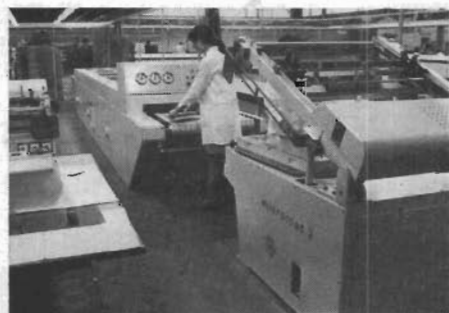
Fig 2. Framställning av foliekort genom screen-tryck
