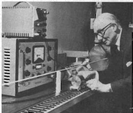
Fig 9. I England håller man på att utveckla en speciell typ av varningsradar för järnvägar. Bilden visar en laboratorieutrustning för detta ändamål.
