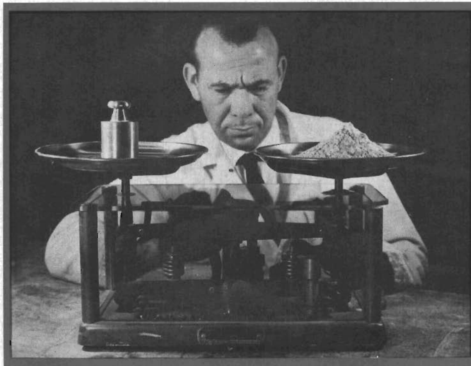
Fig 1. Vid tillverkningen måste de olika ämnena i steatiten balanseras mycket noggrant och råmaterialen måste vara av hög kvalitet och utan föroreningar. Alla verktyg måste rengöras regelbundet.
