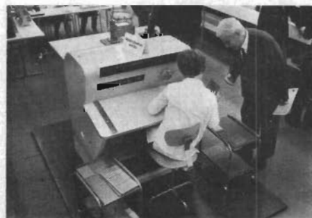
Fig 4. Maskin för skärning av basskivor
