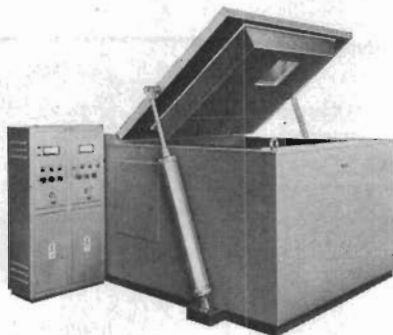
Laboratorie- och materialprovningsskåp för varaktighetslagring vid lågtemperaturer och materialundersökningar ävensom krympningsprocesser för provgodsvikter till 5000 kg.
