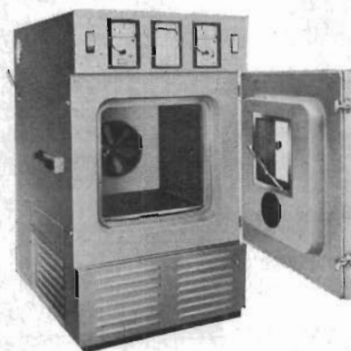
Högeffektiva klimat och växeltemperaturanläggningar från 180 till 1500 i nyttovolym för undersökningar enl. MIL, ASTM, IEC, DEF, AFNOR, DIN och VDE.
