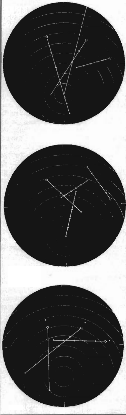
Fig. 2. Den översta indikatorbilden visar relativa kurslinjer för tre fartyg med markeringar var sjätte minut. Det egna fartygets kurslinje har inga tidmarkeringar. På bilden i mitten finns tidmarkeringar även längs det egna fartygets kurslinje. Längst ned visas den bild man får på indikatorn om det egna fartyget ändrar kurs 30^\circ styrbord; det kommer då inte att skära någon av de andra fartygens kurser.
