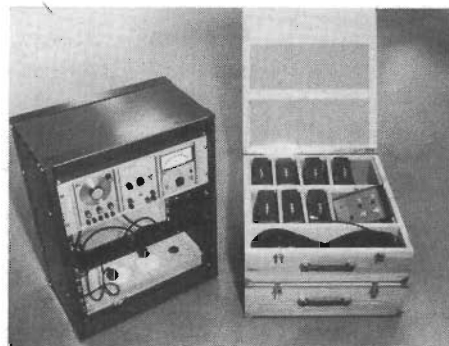
Fig 2. Utrustning för uppbyggnad av »fältlaboratorium». I stativet finns en generator för puls- och sinusspänningar, en förstärkare och en elektronisk voltmeter. I lådan finns kablar och anslutningsenheter. De senare placeras på varje laborationsplats.
