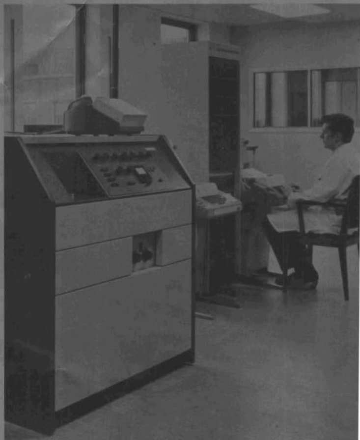
Helautomatisk röntgenspektrometeranläggning installerad hos Boliden AB, Reymersholmsverken. Systemet består av en unik och mycket flexibel kombination av röntgenspektrometer, röntgendif-
