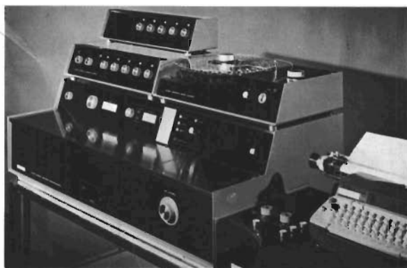
Automatisk spektrofotometer Unicam SP 3000 för ultraviolettera och synliga våglängdsområdet. Den första med inbyggd digital presentation av absorptionen eller transmissionen. Unikt fotometriskt system ger stor reproducerbarhet — \pm 0,001 A. Programmering av upp till 10 fasta våglängder.
