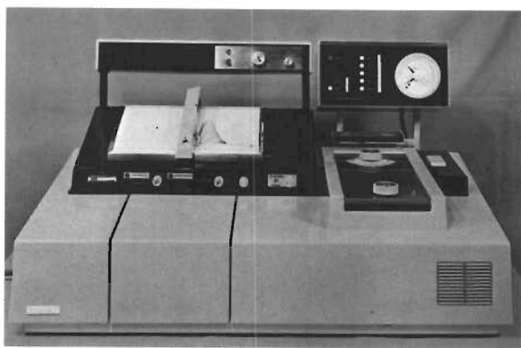
Scanspektrofotometer Unicam SP 800 för synliga och ultraviolettera våglängdsområdet. Automatisk provväxling för 4 prover och 4 referenser. Inbyggd skrivare. Stort antal tillbehör.
