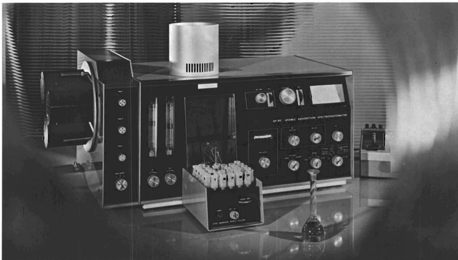
Atomabsorptionsspektrofotometer Unicam SP 90 för såväl forskning som rutinanalyser. Lampväxlare för tre lampor, skalexpansion, flamemission, N_2O -tillsats, flerslitsbrännare, provväxlare för 32 prover , digitalutgång.
