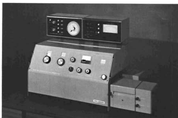
Precisionsspektrofotometer Unicam SP 500 serie 2. Enkelstrålig med automatisk provväxling för 3 prover och 1 referens. Lämplig för kinetiska mätningar. Kan även anslutas till den automatiska kemienheten Unicam AC 60.
