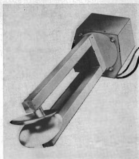
Fig 9. Mätgivaren till Valmets utrustning för mätning av pappersformeringen i pappersmaskin.
