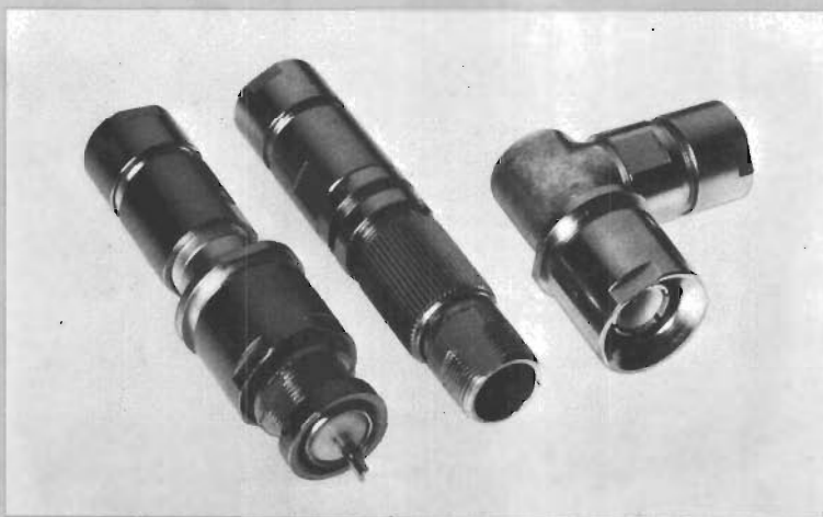
Koaxialkontakter storlek 1,6/5,6 Z = 75\Omega , upp till 1000 MHz, raka eller vinklade, förgyllda kontaktdelar, temperaturområde -55^\circ till +150^\circ C.
