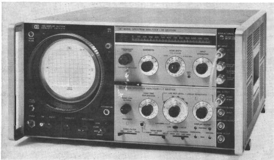
Fig 1. Hewlett-Packards nya spektrumanalysator för frekvenser upp till 1,25 GHz har absolut kalibrering både vad gäller amplitud och frekvens. Förutom HF-delen, modell 8554L, består analysatorn av en MF-del, modell 8552A och en presentationsdel, modell 141S.
