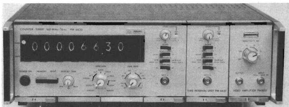
Fig 4. PM 6630 ses här monterad i 19" låda tillsammans med tidintervallenhet (PM 6631) och förstärkare (PM 6633).
