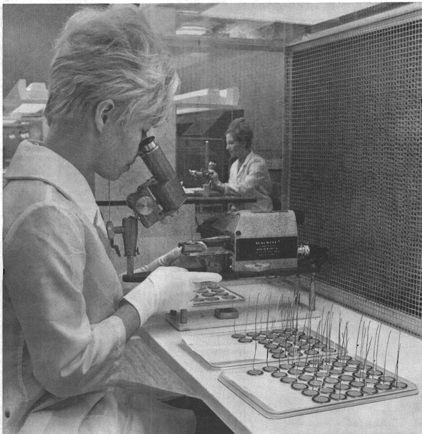
ULTRALJUDSSVETSNING AV STYRELEKTROD TILL TYRISTORELEMENT
