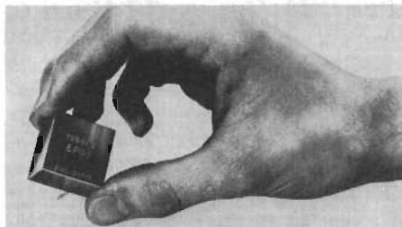
Fig 3. Det minsta överspänningsskyddet EPO 1 för 1 A har dimensionerna 17 \times 27 \times 27 mm .
