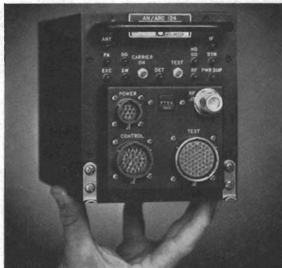
Fig 8. Flygburen datakommunikationsutrustning för frekvensområdet 225–400 MHz från ECI. Bärvågseffekt 20 W.
