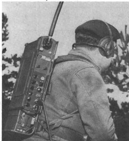
Fig 15. Digital syntesgenerator från Plessey, avsedd för bärbar kortvågsstation, 2–30 MHz.
