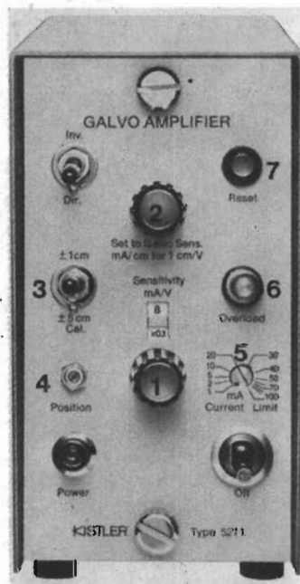
Fig 1. Galvanometerförstärkare typ Kistler 5211, speciellt lämpad för HF-galvanometrar
