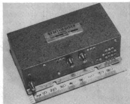
Fig 15. Digital syntesgenerator från Plessey, avsedd för bärbar kortvågsstation, 2–30 MHz.
