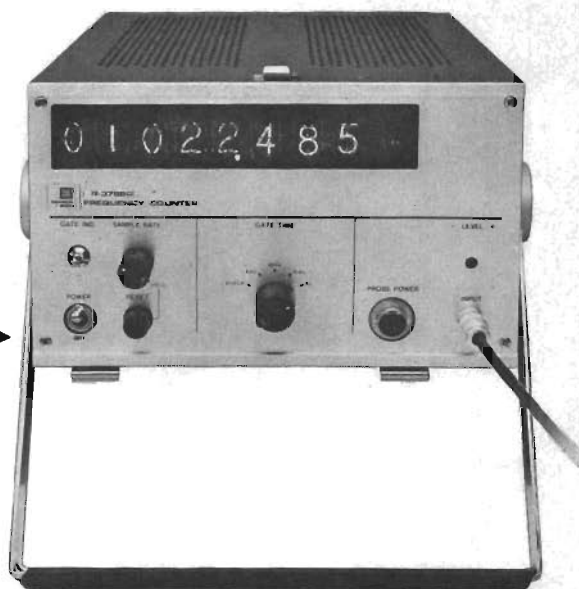
TR 3788 C Direktvisande 500 MHz frekvensräknare. ▶ Frekvensområde 10 Hz — 500 MHz Frekvensstabilitet bättre än 3 \times 10^{-9} /dag Samplingstid 80 ms — 5 s Känslighet 10 mV rms
