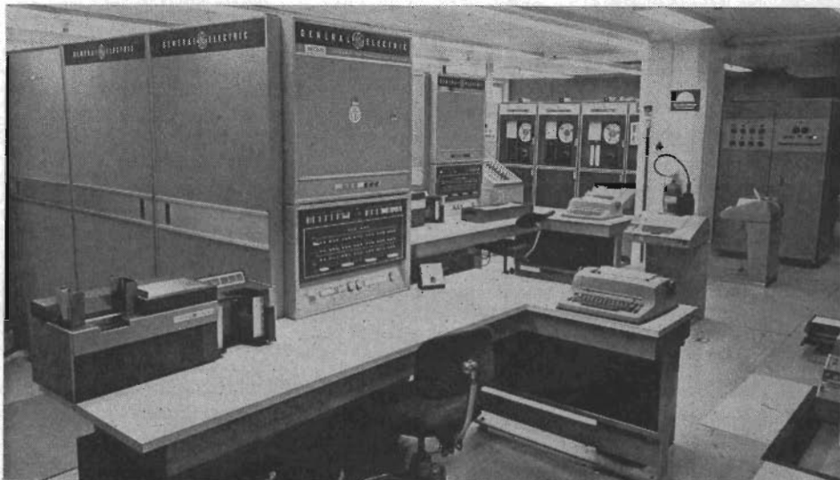
Fig 4. Datacentralen vid Honeywell Bull AB i Stockholm betjänar via telefonnätet time-sharing-abonnenter i Sverige, Norge och Finland. Dessa båda datorer av typ GE-265 och GE-275 arbetar obemannade dygnet om.
