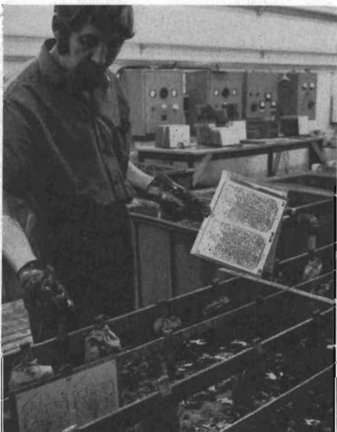
Här sker den elektrolytiska genompläteringen.
