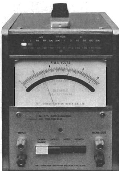
◀ M175 Förstärkarvoltmeter med automatisk mätområdesinställning. Spänningsområde 1 mV — 300 V i steg om 10 dB Frekvensområde 6 Hz — 1 MHz Noggrannhet bättre än 3 % In impedans 1 Mohm // 30 pF
