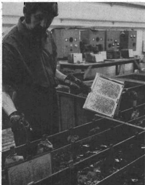
Här sker den elektrolytiska genompläteringen.
