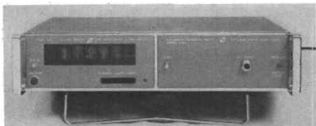
Fig 3. EIP:s automatiska frekvensmeter täcker 3 – 20 GHz.
