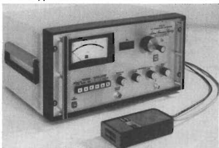
Fig 5. Airbornes nya dämpningskalibrator 137 mäter HF-dämpning högre än 100 dB med en noggrannhet bättre än 0,4 dB.
