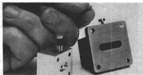
Fig 13. Mekaniskt avstämbara Gunn-oscillatorer från Varian.
