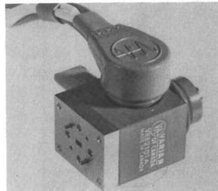
Fig 10. Varians reflexklystron för flygburna utrustningar.
