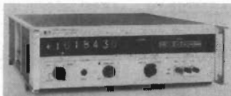
Fig 2 H-Ps digitalvoltmeter 3462A med extremt hög ingångsresistans
