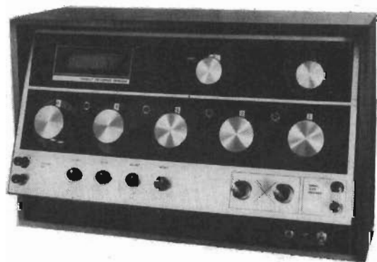
T 1098 Resistansbrygga, 0,001 ohm—10 Mohm inbyggt 0-instrument, nätansluten.
