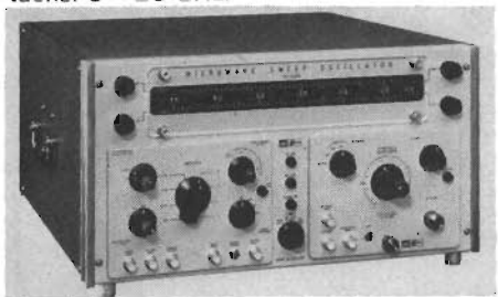
Fig 4. Marconis licensbyggda svepgenerator, typ 6600A.
