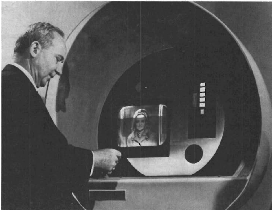
Fig 4. I en datorterminal av denna typ framträder banktjänstemannens bild på TV-skärmen sedan kunden fört in sitt hålkort. Den ekonomiska transaktionen görs därefter automatiskt.
