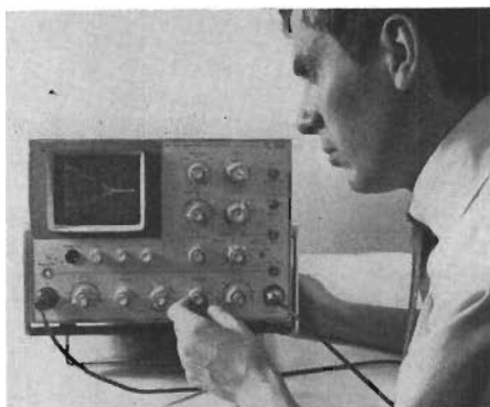
Fig 1. Philips nya svenskbyggda sampling-oscilloskop PM 3400.
