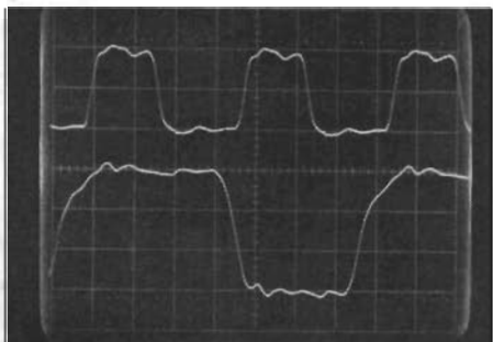
Fig 5. Så här kan kurvformerna se ut när man mäter med passiv prob i digitala integrerade TTL-kretsar.
