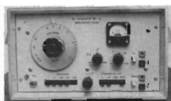
Fig 1. Skolelektros nya LF-generator har 2 W uteffekt och är skyddad mot oavsiktliga höga yttre spänningar på utgången.
