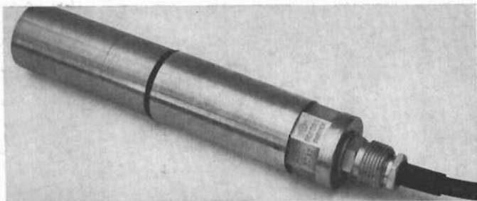
Fig 3. Skjuvkraftgivaren, totalvy och principskiss.
