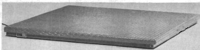
Fig 7. Plattformsvåg med skjuvkraftgivaren som avkännande element. Mätområde 800 Kp. Mått 1200 x 1200 x 90 mm. Observera den låga höjden.
