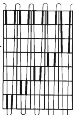
Fig 2. Teckenskrivning med hjälp av fem bläckstrålar J. Genom lämplig intensitetsmodulering åstadkommes punkter på önskade ställen.
