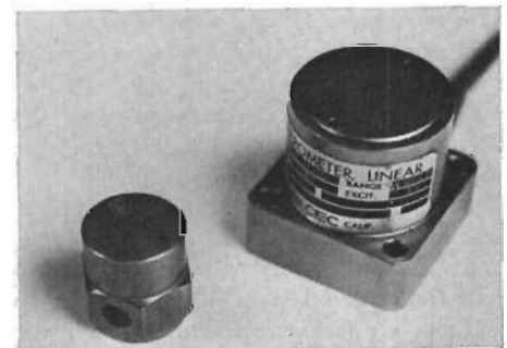
Fig 7. Accelerometrar av modernt utförande. Den mindre tv (fabr Brüel & Kjør) har piezokristall som mätlement och den större th (fabr Bell & Howell) är utrustad med frispända trådtöjningsgivare som mätlement.
