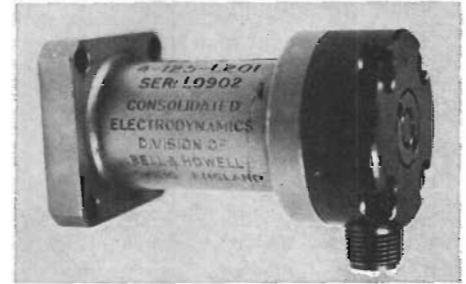
Fig 6. Hastighetsgivare av genererande seismisk funktionsprincip (fabr Bell & Howell). Givaren får relativt långsträckt form p g a att den är dimensionerad för stora amplituder (ca 10 mm) vid låga frekvenser.
