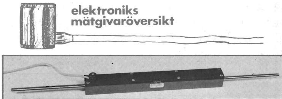
Fig 2. Mätpotentiometer (fabr SWEMA) för rätlinjig rörelse. Potentiometern har axeluttag i varje ände och resistansbanan är trådlinad.
