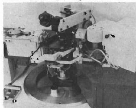
Fig 2. Prototyp av halvautomatisk bondningsmaskin byggd vid Philips halvledarfabrik i Nijmegen
