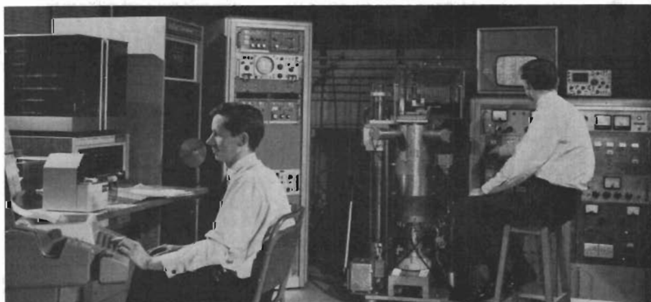
Fig 11. Vid Mullard Research Laboratories bedriver man försök med masktillverkning med hjälp av en datorstyrd elektronstrålefräs. Själva fräsenheten liknar överdelen på ett elektronmikroskop, se bildens mitt.
