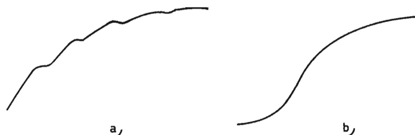
Fig 5. Kombinationer av de i fig 4 visade stegsvaren: a) ett snabbt, underkritiskt dämpat andra ordningens block och ett långsamt första ordningens, b) flera, snabba och långsamma, första ordningens system.
