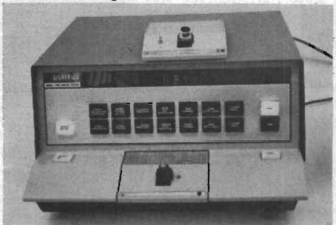
Fig 7. Signetics programstyrd provare för linjära kretsar, typ 1420.
