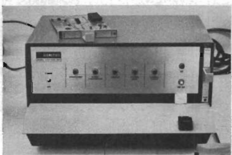
Fig 8. Programstyrd provare från Signetics för digitala kretsar, typ 1110.
