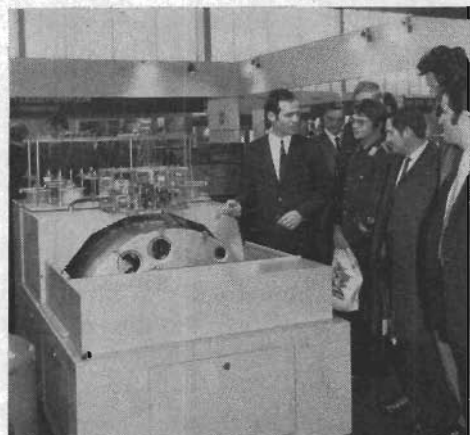
Fig 10. Kabelautomaten från VEB Elektromat i Dresden syr ut kabelstammar med upp till 1 250 mm längd och 540 mm bredd, styrd av en fem- eller sjukanalig hålrämsa.
