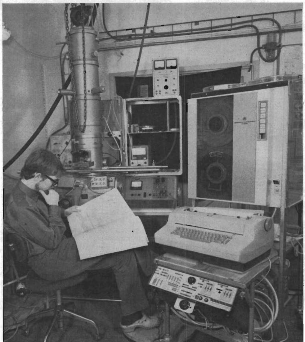
Fig 1. Laboratorieutrustning för elektronstrålegenerering av maskor till monolitkretsar. Till höger syns den digitala styrutrustning som omnämns i texten. Till vänster visas den elektronstråleenhet som utför exponeringen av fotoresisten men som också kan användas som ett avsökande elektronstrålemikroskop.
