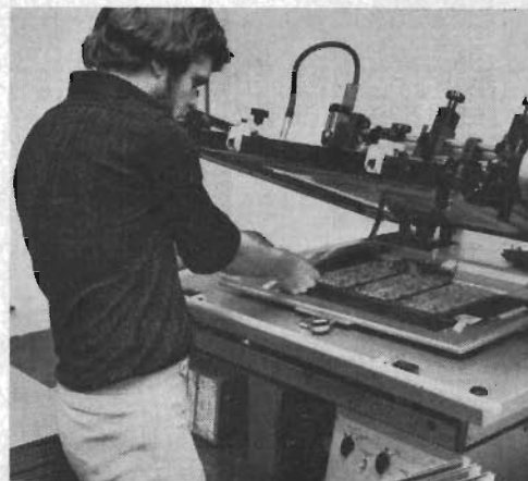
Noggrant mönstertryck – fina inställningsmöjligheter med halvautomatiskt screentryck.
