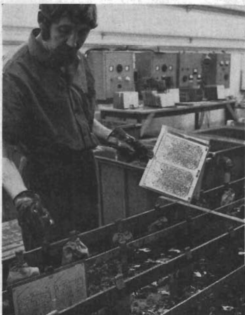
Här sker den elektrolytiska genompläteringen.
