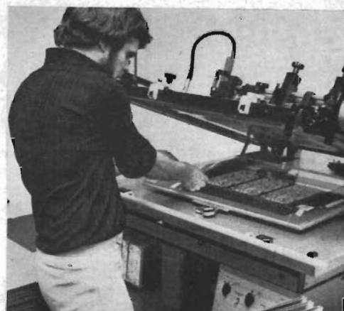
Noggrant mönstertryck – fina inställningsmöjligheter med halvautomatiskt screentryck.
