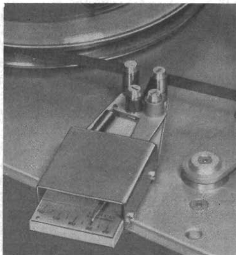
Fig 5. En liten Lyrecspecialitet är en sk Tape Tension Meter, som kan användas på flera sätt för att kontrollera den mekaniska spänningen hos inspelningsbandet. Fig 5a visar mätning direkt över avspelningshuvudet, 5b mätning vid avspolningstallriken och fig 5c visar mätning av bandspänningen vid uppspolningstallriken.
