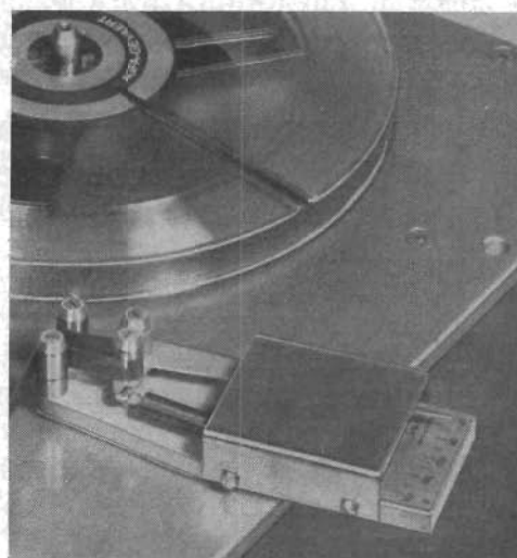
Fig 5. En liten Lyrecspecialitet är en sk Tape Tension Meter, som kan användas på flera sätt för att kontrollera den mekaniska spänningen hos inspelningsbandet. Fig 5a visar mätning direkt över avspelningshuvudet, 5b mätning vid avspolningstallriken och fig 5c visar mätning av bandspänningen vid uppspolningstallriken.
