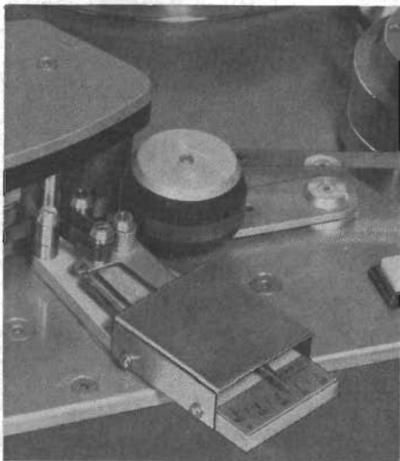
Fig 5. En liten Lyrecspecialitet är en sk Tape Tension Meter, som kan användas på flera sätt för att kontrollera den mekaniska spänningen hos inspelningsbandet. Fig 5a visar mätning direkt över avspelningshuvudet, 5b mätning vid avspolningstallriken och fig 5c visar mätning av bandspänningen vid uppspolningstallriken.
