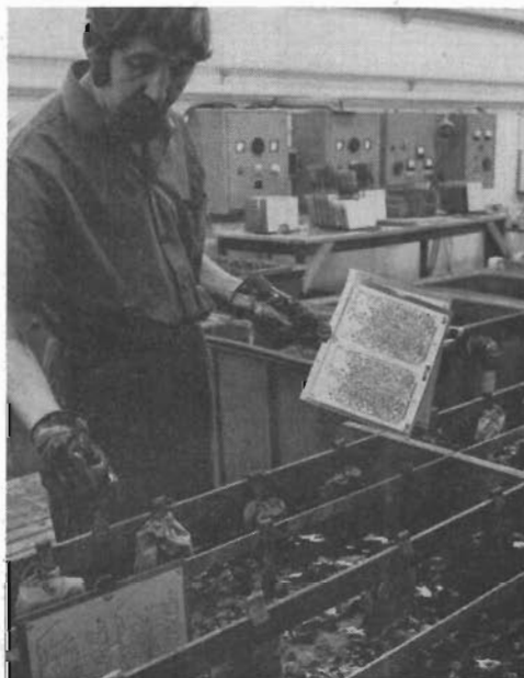
Här sker den elektrolytiska genompläteringen.
